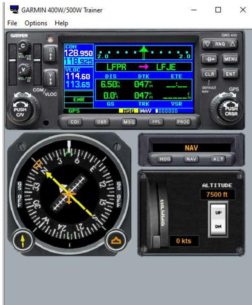
Ce simulateur est équipé d'un GPS 430 ainsi que d'un petit dispositif de navigation avec pilote automatique afin de pouvoir se déplacer. L'ensemble du GPS est fonctionnel comme le réel.
