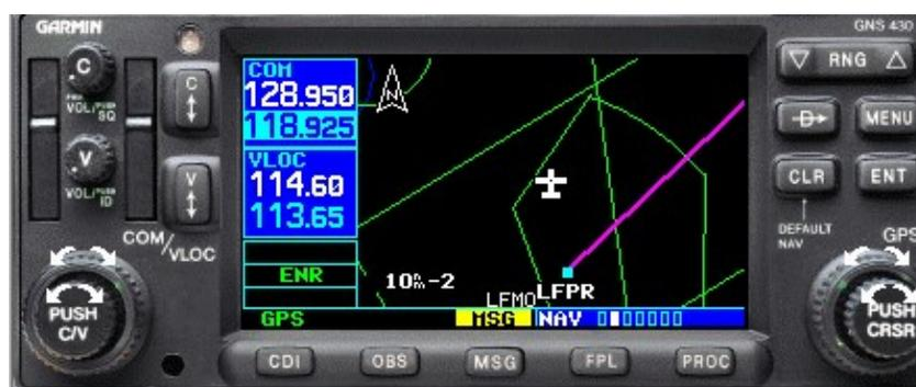
Une fois nos exercices terminés au nord de LFPR (image ci-dessus), pour reprendre notre navigation vers LFJE depuis notre nouvelle position, il nous suffit d'appuyer sur DIRECT TO, et étant donné que notre prochain point est conforme à celui de mon plan de vol, à savoir LFJE, il nous le sera proposé automatiquement.
